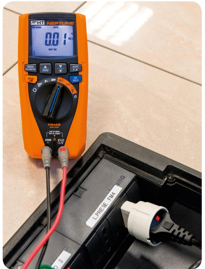
Misura **Resistenza di Isolamento** (Adattatore Schuko C2065 opzionale).
